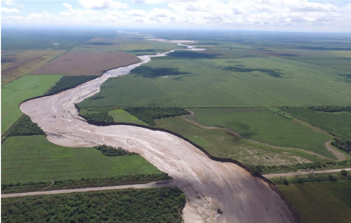
Figura 6-A – Ruta Provincial 334 en cruce del San Francisco (vista al norte). Se aprecia en la lejanía el canal de desvío del río ejecutado por productores agrícolas y las consecuencias de erosión profunda (fuente: DPV Tucumán)
